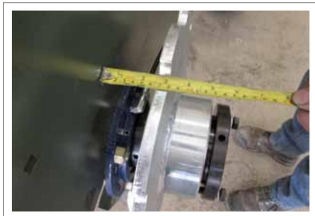
**FIG 9-5 SPROCKET POSITION**
