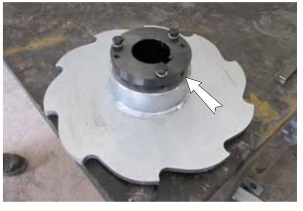
FIG 9-1 REVERSER SPROCKET
